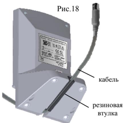
**Примечание:** Для обеспечения максимального удобства использования аппарата в процессе работы, а также для предотвращения поломки рабочего кабеля, предусмотрена возможность вывода кабеля на лицевую сторону аппарата.
